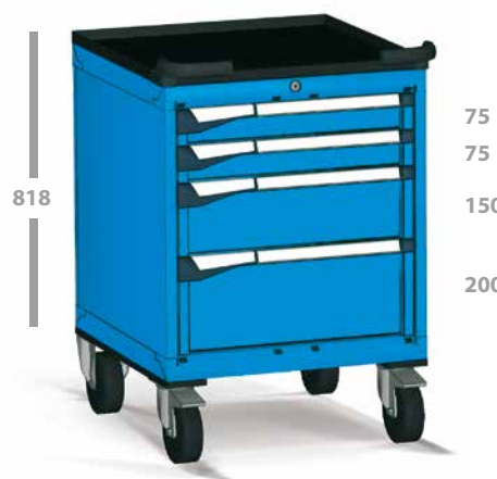
Schrank mit 4 Schubladen, Rollen aus Standardgummi Ø 125 mm. Tragkraft des Schrankes: 235 kg Abm. 587 x 647 x 818 mm RAL 5012 lichtblau
