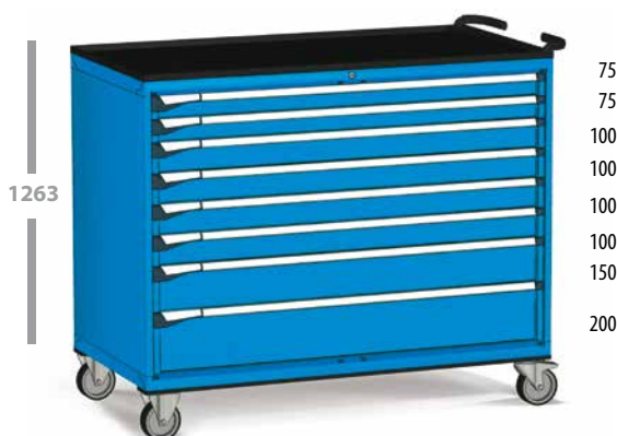
Schrank mit 8 Schubladen, Rollen aus elastischem Gummi Ø 160 mm. Tragkraft des Schrankes: 600 kg Abm. 1508 x 752 x 1263 mm RAL 5012 lichtblau
