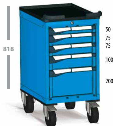
Schrank mit 5 Schubladen; Rollen aus Standardgummi Ø 125 mm. Tragkraft des Schrankes: 245 kg Abm. 434 x 647 x 818 mm RAL 5012 lichtblau
